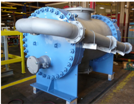
Этот конденсатор выпара с аммиачным десорбером, успешно заменивший протекающий сварной блочный теплообменник, имеет два съемных пакета пластин с одним кожухом.
