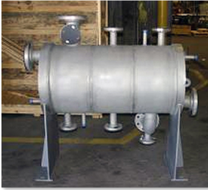
Этот многофункциональный многоходовой теплообменник используется при очистке газа от соединений серы с помощью аминов.
