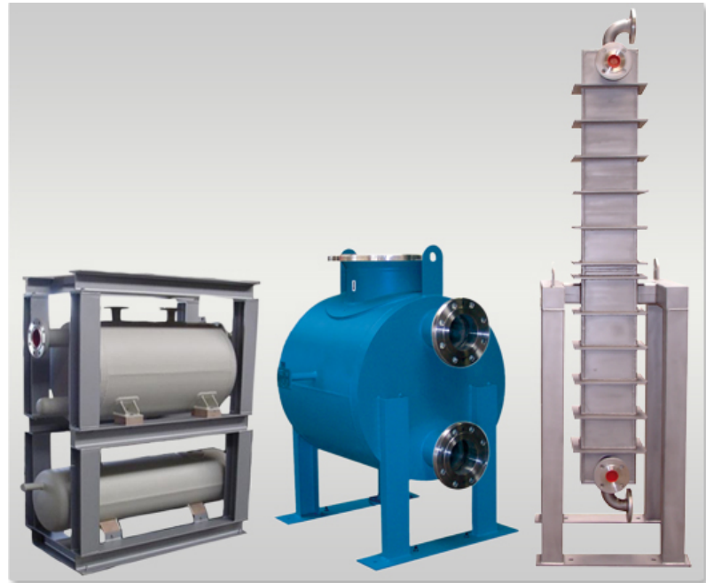
Примеры универсальности кожухо-пластинчатых теплообменников (слева направо): R404a- DX-cascade с круглыми пластинами с коллектором CO 2 , конденсатор во внутренней зоне с большим расходом и теплообменник два-в-одном с овальными пластинами с повышенной длиной нагретого участка, устанавливаемый в установках для обезвоживания газа.
